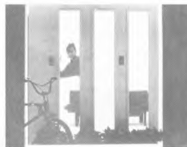
Figura 4: Os cristais líquidos em arquitectura e na construção civil: o painel do meio está no seu estado opaco ao passo que os painéis laterais estão transparentes. Um simples interruptor faz a mudança.
