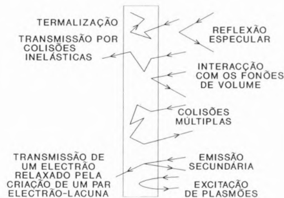
Fig. 8 - Algumas das interacções possíveis entre um electrão incidente e um meio sólido.
