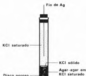
Figura 4. Diagrama de um eléctrodo de prata/cloreto de prata.
