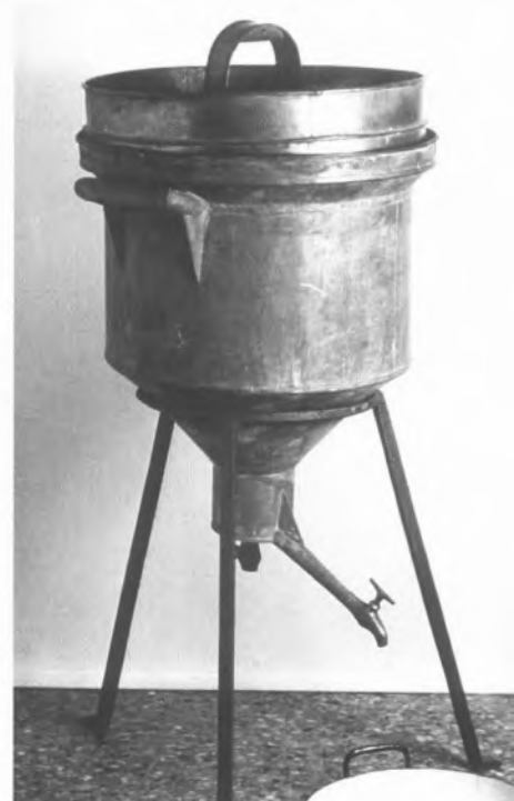
Figure 1. Calorimètres à glace de Lavoisier et Laplace. (Photos J. C. Wetzel, © Musée des Arts et Métiers-Paris)
