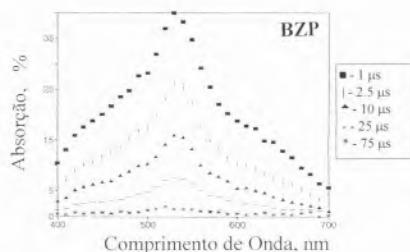
Fig. 14 - Espectro de absorção resolvido no tempo de cristais de BZP.
