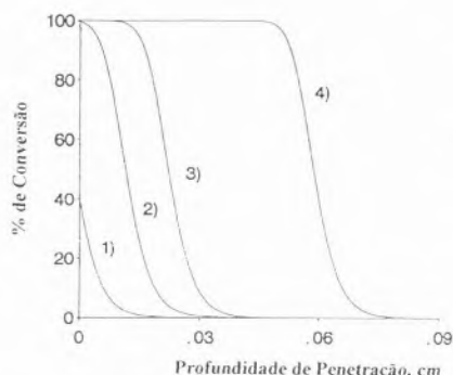
Fig. 13 - Perfis de concentração da espécie excitada em função da profundidade de penetração da radiação de excitação laser.
