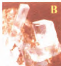
Fig. 2 - O sal de Rochelle KNa(C_4H_4O_6) \cdot 4H_2O . A - puro, preparado pelo método geral (139 g/100 ml de água). B- Adsorção superficial de íons Cu(II) , "águas-marinhas", com alteração do hábito cristalino mais frequente (A) para colunar(B) [2, 3, 7].
