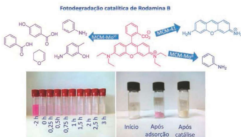
Figura 4 – Produtos resultantes da fotodegradação da Rodamina B e evolução temporal da degradação do corante em solução e no catalisador
