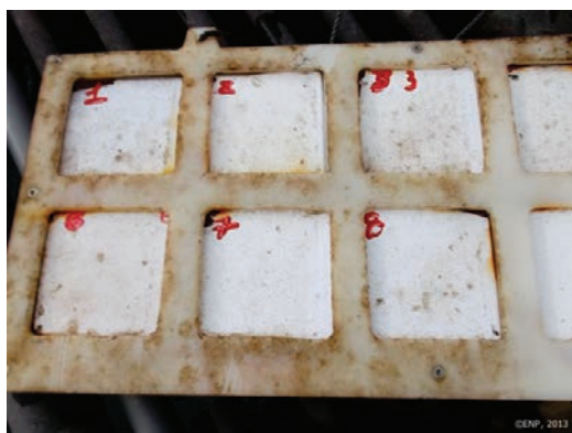
Figura 6 – Efeito anti-incrustante de revestimentos de poliuretano, contendo biocidas à base de Irgarol e/ou Ecomea imobilizados, expostos em mar português por (a) 3 semanas e (b) imagem ampliada de uma formulação exposta até à 14. a semana, revelado a adesão reversível de biofilme. Fotos tiradas e cedidas pelos Estaleiros Navais de Peniche (ENP), Portugal
