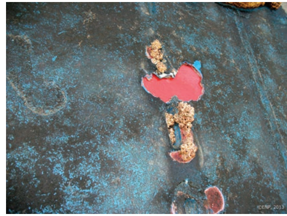
Figura 1 – Bioincrustação num casco de um navio Português (esquerda), detalhes da biocorrosão (direita). Fotos cedidas pelos Estaleiros Navais de Peniche, Portugal
