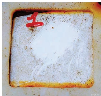
Figura 6 – Efeito anti-incrustante de revestimentos de poliuretano, contendo biocidas à base de Irgarol e/ou Ecomea imobilizados, expostos em mar português por (a) 3 semanas e (b) imagem ampliada de uma formulação exposta até à 14. a semana, revelado a adesão reversível de biofilme. Fotos tiradas e cedidas pelos Estaleiros Navais de Peniche (ENP), Portugal
