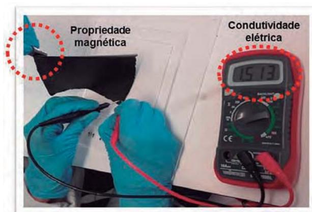
**Figura 4** – Filme de quitosana com incorporação de óxido de grafeno reduzido e magnetite com propriedades magnéticas e condutividade elétrica.
