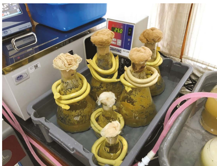
Figura 5 - Frascos de Erlenmeyer em banho termostático a 25 °C, durante o decorrer da fermentação.
