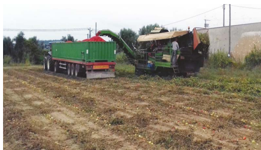
Figura 1 – Máquina de colheita e seleção e contentor com tomate vermelho colhido. Observa-se algum tomate verde deixado no campo. Fotografia de João Santos Silva (Centro de Competências para o Tomate de Indústria - CCTI).
